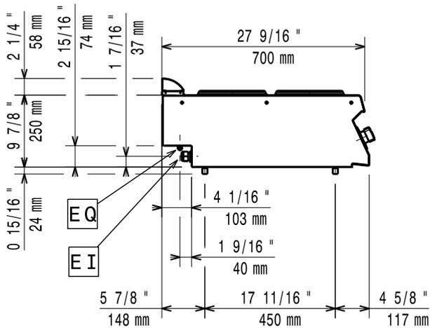
EI = Conexión eléctrica (energía)
